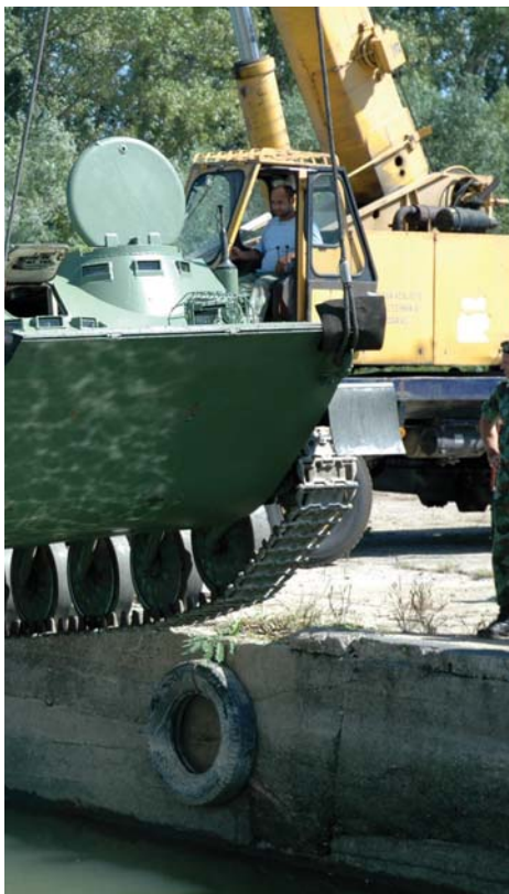
Опитовање стабилности брода на максималном депласману
